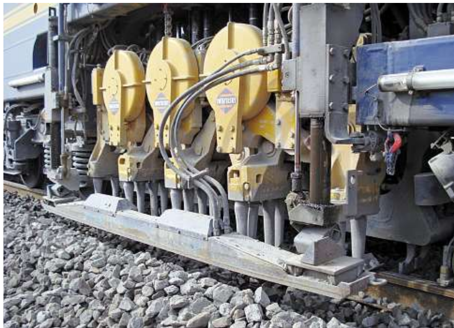
Die Pickel einer Gleisstopfmaschine für die Gleislagekorrektur. Bei grossen Abweichungen der Gleislage sind mehrere Stopfvorgänge notwendig.
