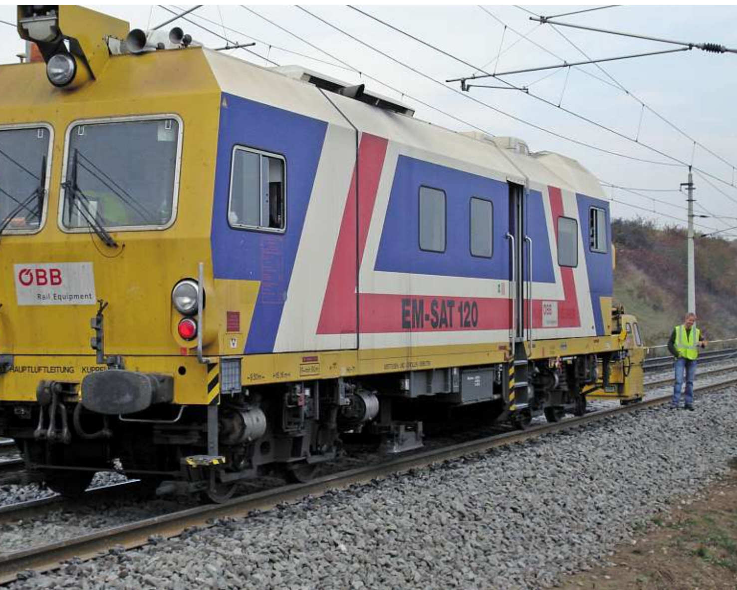
Gleisvermessung der ÖBB mittels EM-SAT 120. Mittels Laser präzise und gleichzeitige Vermessung von Gleishöhe, Richtung, Spurweite und Überhöhung. Durch den Abgleich der Messdaten mit der Sollgeometrie werden die Steuerdaten für die Gleisstopfmaschine ermittelt und per Funk oder Diskette übergeben.
